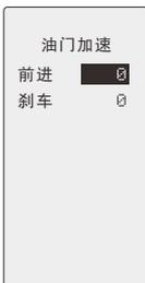
分别调整油门加速、刹车中点附近的瞬间动作量。
