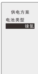
使用不同的电池需要选择不一样供电方案。当然，没有选择正确，也不会导致发射机损坏。不过却会影响电池的寿命。当听到持续的警告音时，表明电池电压过低，请更换新的电池。
