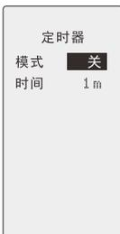
可以在正计时、倒计时、圈计时三种计时模式中选择一种。
