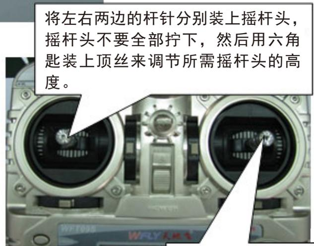
顶丝由此拧下，顶丝的深浅度决定摇杆头的高度。
