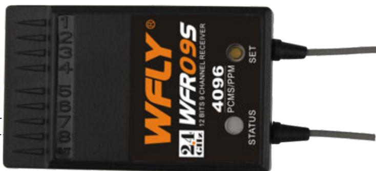
WFLY PCMS接收机可兼容PCMS 4096, PCMS 1024和PPM模式(自适应),且有失控保护功能.
