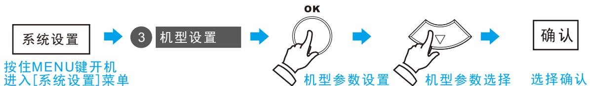
【说明】选择了一种机型编号后，再为其设定机型，可选择三种机型，“直升机”“固定翼”“滑翔机”，选定生效后，本机将会随之变更[参数设置]菜单和[高级设置]菜单。编辑[机型名称]后，可修改为便于记忆的飞机名称，如“GF-450-1”，便于今后再飞时，迅速查找并直接调用。调用后将在[初始界面]中按EXIT键显示本名称。
