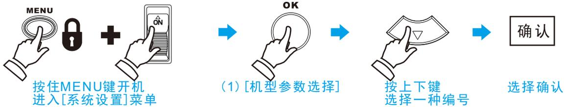
【说明】先要选择一个机型参数的编号，每个编号(可录入名称,以便记忆)都可存储一架飞机模型的所有参数设置值，保存之后,能够在今后使用中直接调出此模型的设置,省却了再次设置的麻烦，普通版的WFT0911可预存15架飞机的参数，超级版WFT09S11可预存85架飞机的参数，需要操控哪一架飞机，直接调出此机型预存的数据即可。
